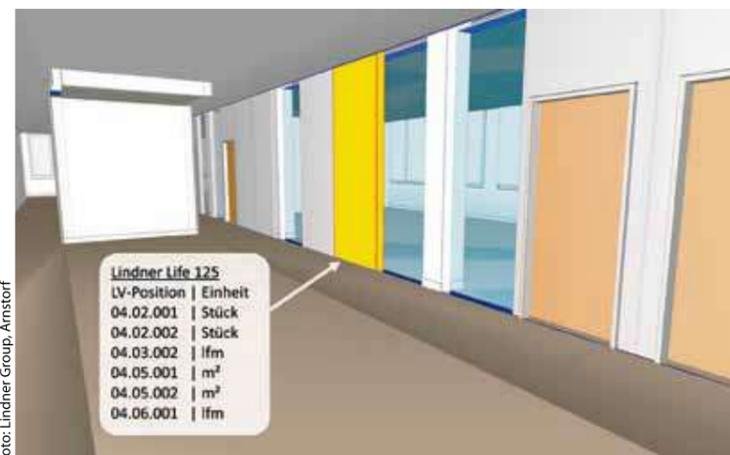
Modelldarstellung der Lindner-Ausbaugewerke als Vorbereitung für die Abrechnung in MWM-Libero.
